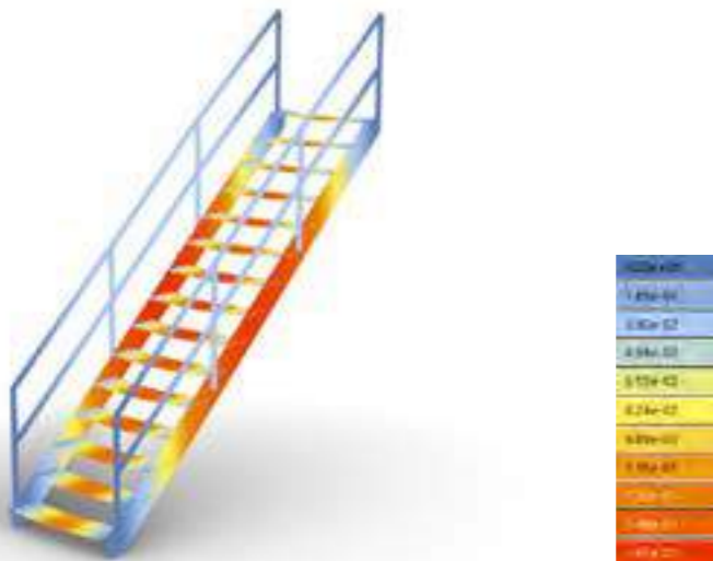
Abbildung 4 Vertikale Verformung der Treppe [cm].
