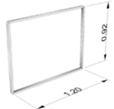
Abbildung 11 Abmessungen der Absturzsicherung Typ 1 [m].
