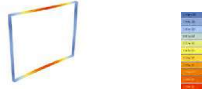
Abbildung 17 Verformung der Absturzsicherung Typ 1 [cm].
